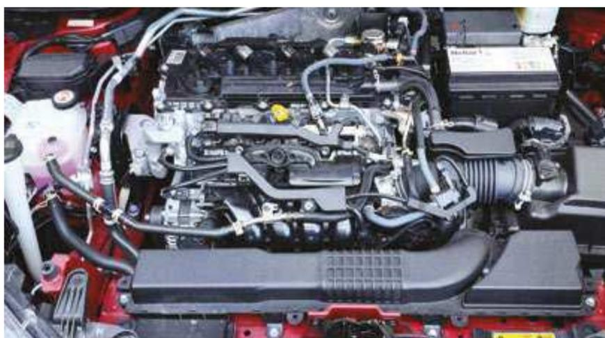
O motor flex 2.0L Dynamic Force de quatro cilindros e 16V entrega 177 cavalos com etanol
