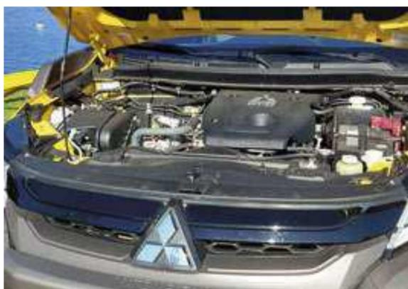
O motor da L200 Triton Savana é um 2.4 turbodiesel de quatro cilindros com 190 cavalos de potência e torque de 43,9 kgfm
