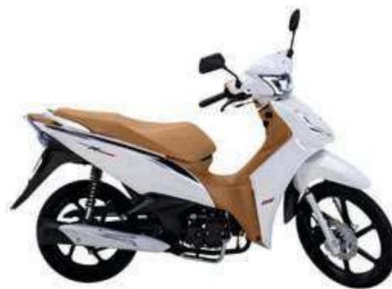
Com peso de 90 quilos, a Shineray Rio 125 tem tanque de 4,2 litros e pode levar carga máxima de 150 quilos
