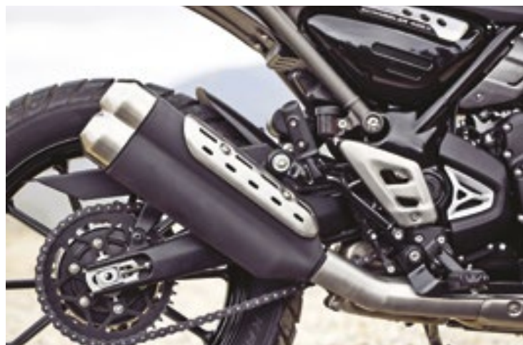
O motor monocilíndrico tem 398 cm 3 , rende 40 cavalos de potência a 8 mil rpm e 3,7 kgfm de torque a 6.500 rpm
