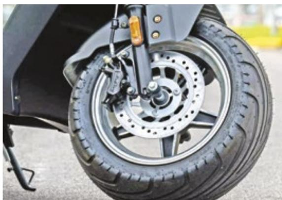
As rodas são de liga leve de 12 polegadas, com aro 165/45 46J na dianteira e 215/40 56J na traseira e freios a disco com acionamento hidráulico
