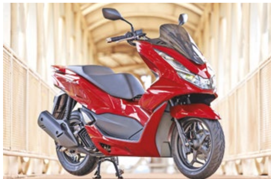
Todas as versões da PCX compartilham o motor monocilíndrico SOHC de quatro válvulas e 156 cm 3 , arrefecido a água
