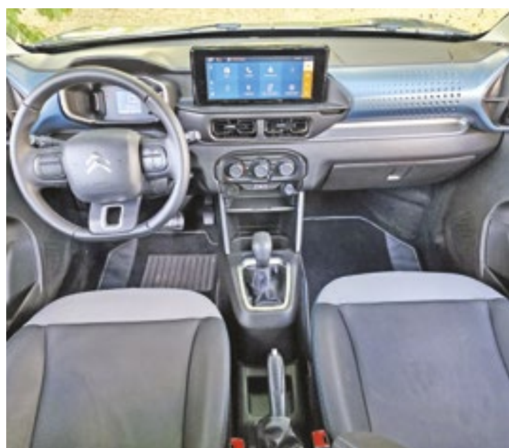
O painel tem visor de TFT com 3,5 polegadas, que exibe o velocímetro digital e os dados do computador de bordo
