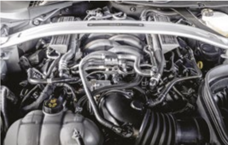
O Mach 1 é movido por um “powertrain” formado por um motor Coyote V8 5.0 e transmissão automática de 10 velocidades
