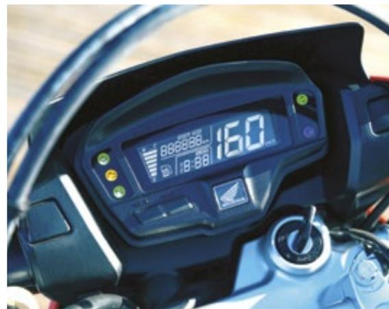
O painel LCD Blackout digital traz conta-giros, velocímetro, hodômetro total e parcial, indicador de combustível e luzes-alerta
