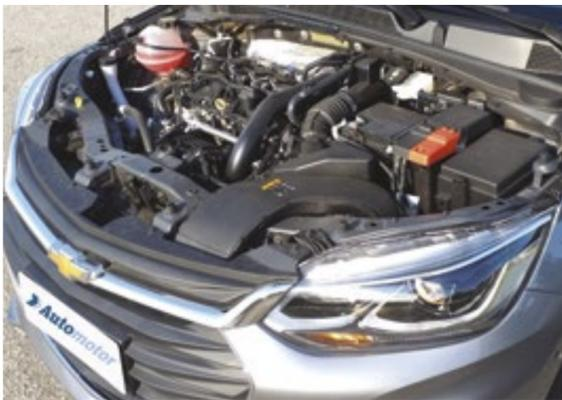
O motor 1.0 turbo flex com três cilindros e 12 válvulas entrega potência de 116 cavalos (com gasolina e etanol) a 5.500 rpm
