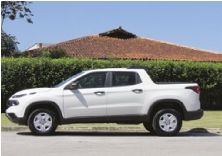
Modelo tem picape monobloco, 4 portas e 5 lugares. Comprimento de 4,94 m, 1,84 m de largura, 1,74 m de altura e 2,99 m de entre-eixos
