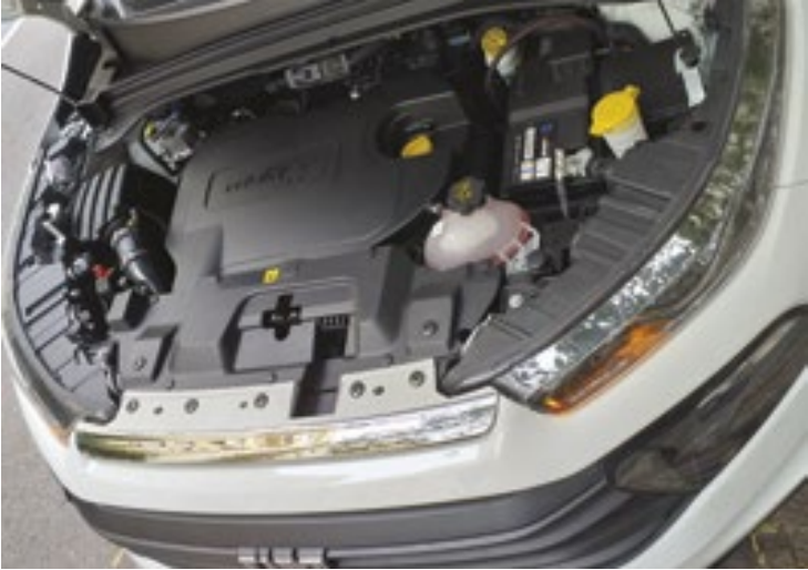
Sob o capô da Endurance está o motor 2.0 Multijet II, que entrega 170 cavalos a 3.750 rpm e 35,7 kgfm a partir de 1.750 giros
