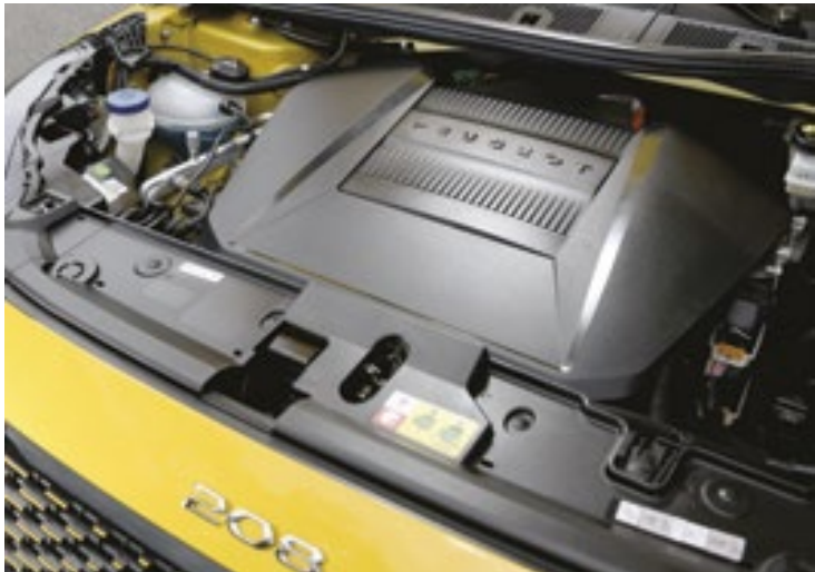
A performance do e-208 GT é garantida por um motor elétrico que entrega 26,5 kgfm de torque e 136 cavalos de potência
