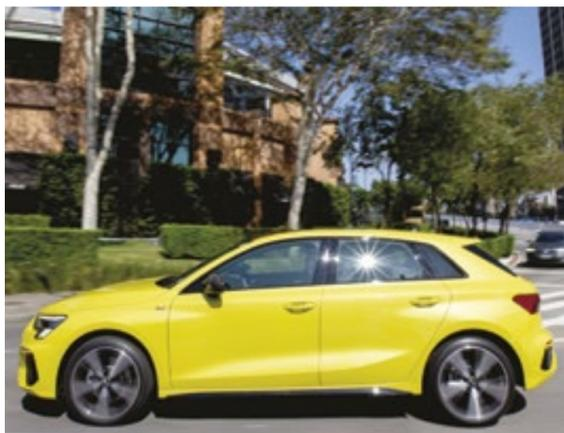
Novo A3 Sportback possui 4,34 m de comprimento, 1,81 m de largura, 1,43 m de altura e 2,63 m de entre-eixos
