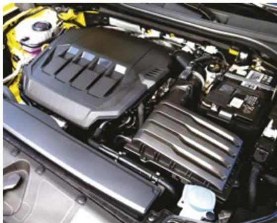
A nova geração do A3 sedã e Sportback chega com o motor 2.0 TFSI a gasolina, com potência de 190 cavalos e torque de 32,6 kgfm
