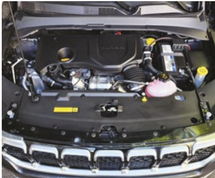
O motor 1.3 T270 tem 180 cavalos com gasolina e 185 cavalos com etanol, ambos a 5.700 rotações por minuto
