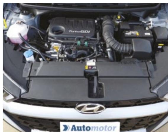
Os motores Kappa 1.0 e Kappa 1.0 TGDI, na configuração de três cilindros com 12 válvulas, são os mesmos já utilizados desde 2019
